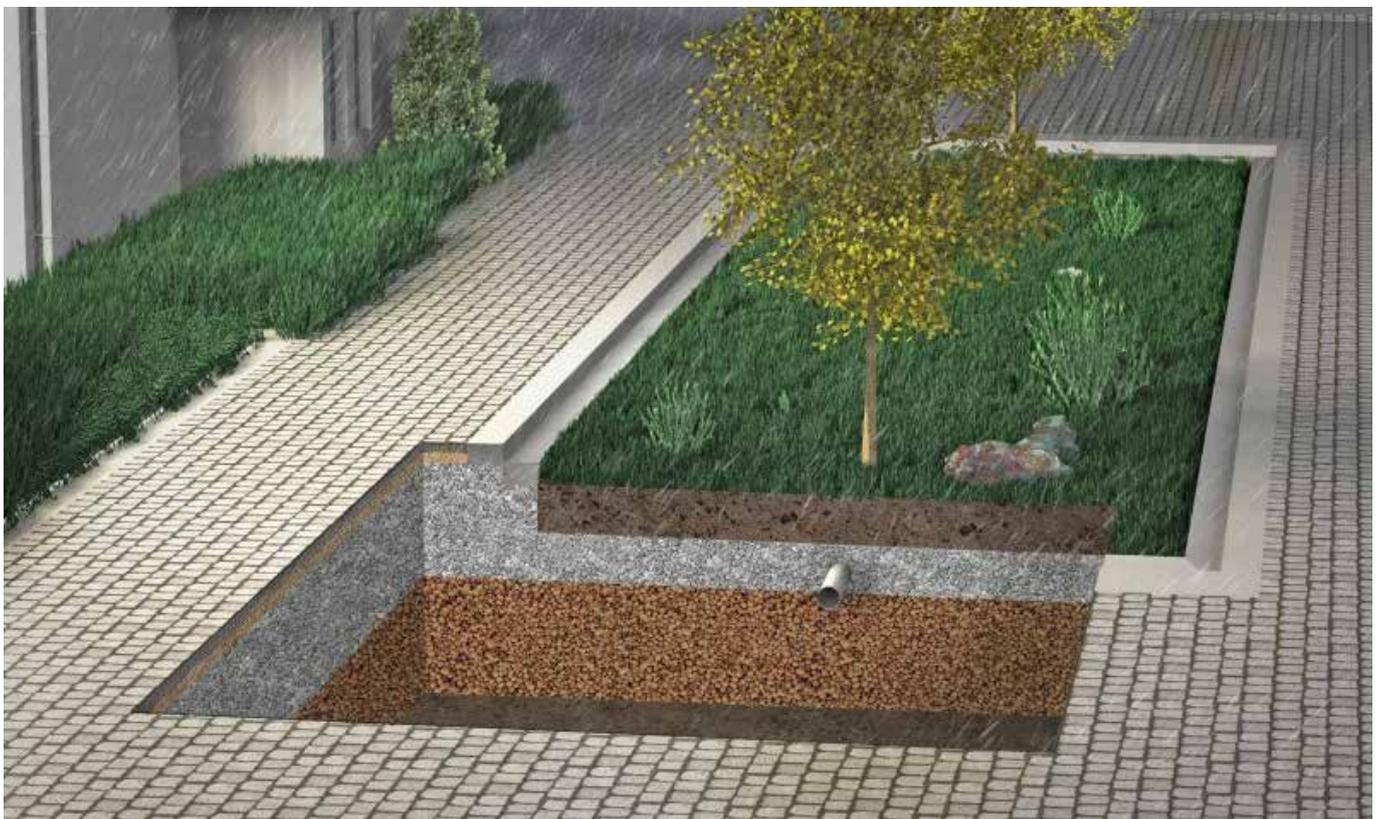
Durch den Einsatz von Fibo ExClay Blähton unter einer durchlässigen Oberfläche werden die Auswirkungen von natürlichen Oberflächen wie Gras, Erde oder Sand verstärkt. Natürliche Oberflächen erhalten ihre Abflusskoeffizienten durch Versickerung, Kapillarsog und Reibung, wie dies auch bei Blähton der Fall ist, da die Materialien auf das Wasser unter der Oberfläche einwirken und weiterhin Wasser zurückhalten.
