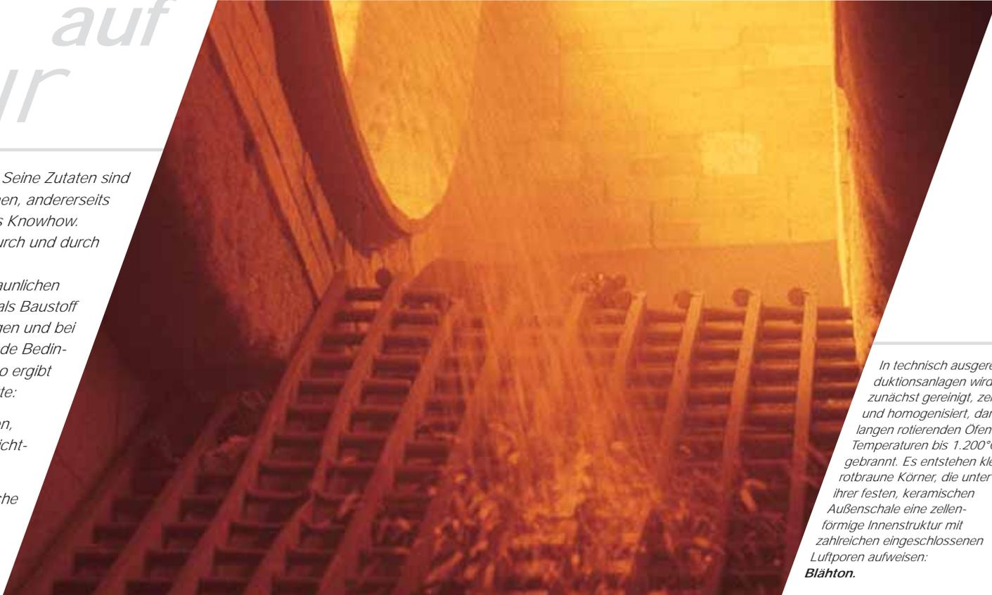
In technisch ausgereiften Produktionsanlagen wird der Ton zunächst gereinigt, zerkleinert und homogenisiert, danach in langen rotierenden Öfen bei Temperaturen bis 1.200°C gebrannt. Es entstehen kleine rotbraune Körner, die unter ihrer festen, keramischen Außenschale eine zellenförmige Innenstruktur mit zahlreichen eingeschlossenen Luftporen aufweisen: **Blähton.**
