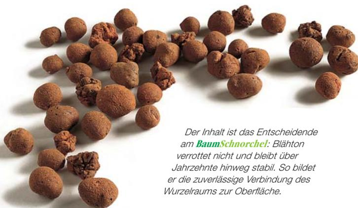
Der Inhalt ist das Entscheidende am **BaumSchnorchel**: Blähton verrottet nicht und bleibt über Jahrzehnte hinweg stabil. So bildet er die zuverlässige Verbindung des Wurzelraums zur Oberfläche.
