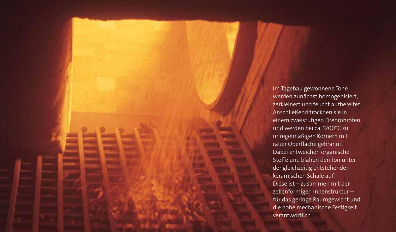
Im Tagebau gewonnene Tone werden zunächst homogenisiert, zerkleinert und feucht aufbereitet. Anschließend trocknen sie in einem zweistufigen Drehrohrföfen und werden bei ca. 1200°C zu unregelmäßigen Körnern mit rauer Oberfläche gebrannt. Dabei entweichen organische Stoffe und blähen den Ton unter der gleichzeitig entstehenden keramischen Schale auf. Diese ist – zusammen mit der zellenförmigen Innenstruktur – für das geringe Raumgewicht und die hohe mechanische Festigkeit verantwortlich.
