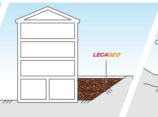
Füllungen mit **LECAGEO** gegen Kellerwände haben wärmedämmende und dränende Wirkung, mindern den Erddruck gegen die Wände und reduzieren Setzungen.
